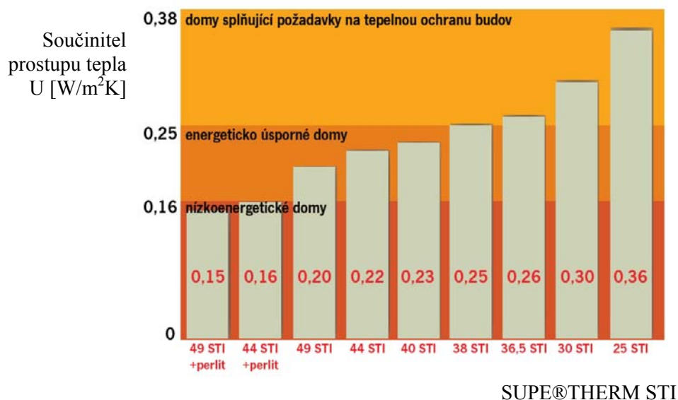
Graf. 1 Graf porovnání parametrů cihelných bloků SUPE@THERM STI s požadavky normy ČSN 73 0540-2
